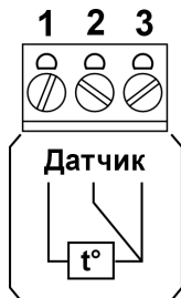
Рисунок 2. Клеммная колодка для подключения датчика t^{\circ} к ICEFREE TR-20
