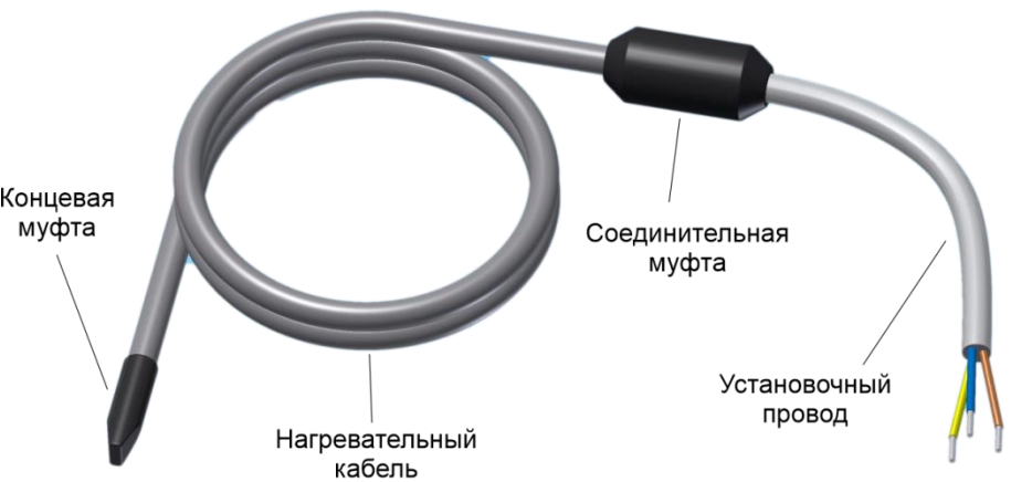
Рисунок 1. Строение нагревательной секции
