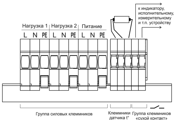
Рисунок 4. Назначение клеммников на клеммной колодке термостата ICEFREE-Ex (M3).
