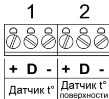
Рисунок 3. Клеммные колодки для подключения датчиков к ICEFREE TD
